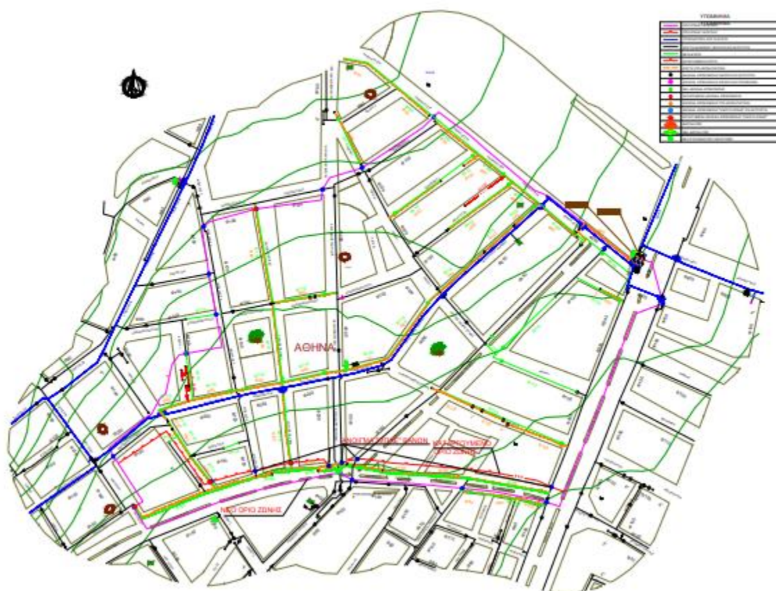
Εικόνα 4.: Γενική Διάταξη Έργων Πιεζομετρικής Ζώνης PRV Λάμψα
